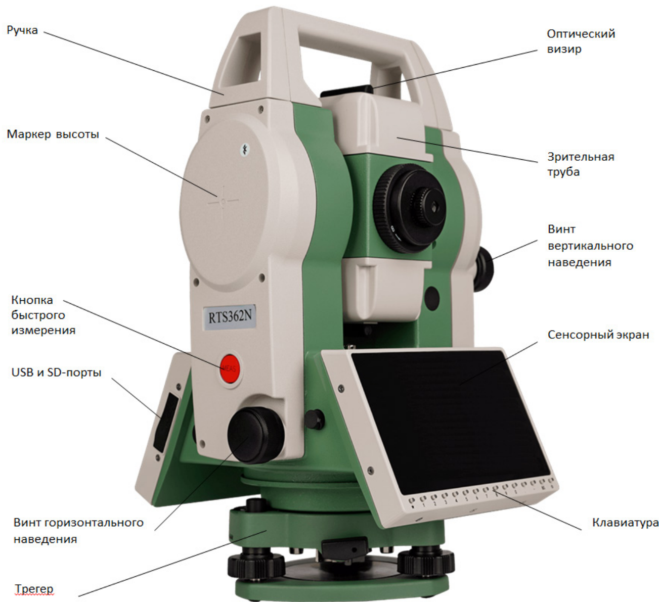
Рисунок 3 - Основные элементы тахеометра RTS362N и RTS010N
